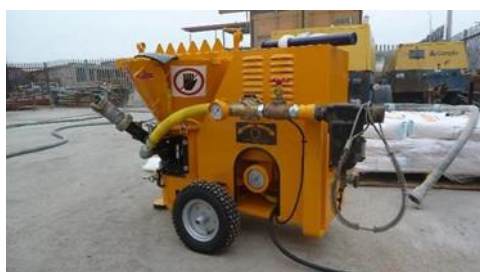
Photos 13 : Pompe SOVE à alimentation électrique avec collecteur de poussière
