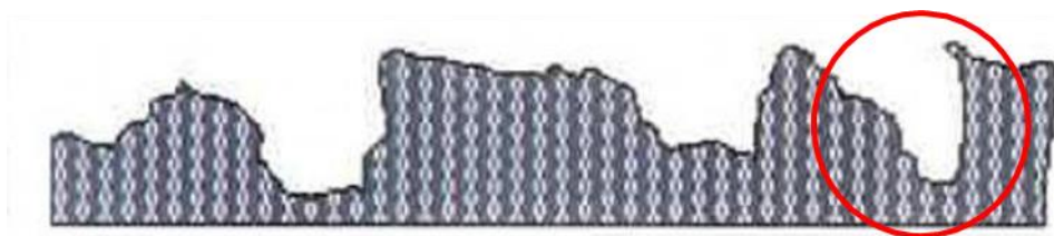
Schéma 4 : Rugosités et cratères inacceptables
