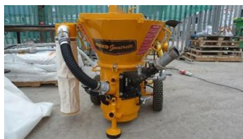
Photos 13 : Pompe SOVE à alimentation électrique avec collecteur de poussière
