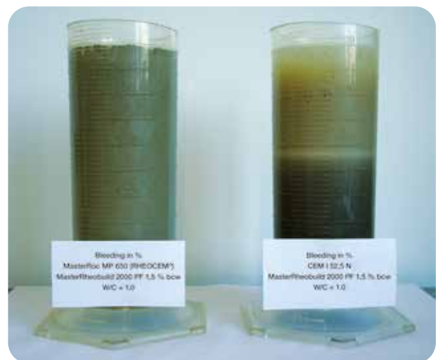
Stabil (venstre) vs. ustabil (høyre) mørtel
