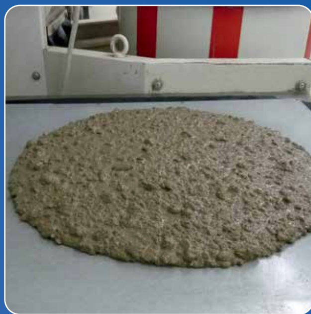
Beton med fint tilslag indeholdende problematiske lertyper - med MasterSuna SBS
