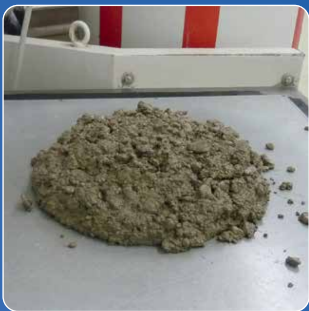
Beton med fint tilslag indeholdende problematiske lertyper - uden MasterSuna SBS
