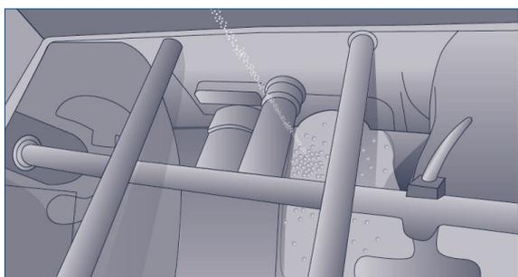
Agiter le mélange en actionnant la pompe jusqu'à dissolution complète de la poudre. Afin d'obtenir un mélange et une efficacité optimales, il est recommandé après adjonction du MasterRoc<sup>®</sup> LUB I, d'actionner la pompe 2-3 fois en arrière.
