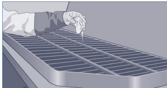
Ajouter 1 sachet (200 g) dans la trémie de la pompe à béton, remplie avec 25 litres d'eau. Augmenter la quantité en fonction de la longueur des conduites de la pompe ou pour des pompes à béton plus grandes.
