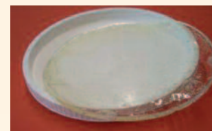
MasterRoc MP 350 dopo stagionatura all'aria umida
