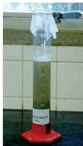
Schema della prova per la determinazione del tasso di sedimentazione
