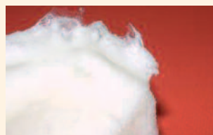
MasterRoc MP 350 dopo reazione schiumosa in acqua
