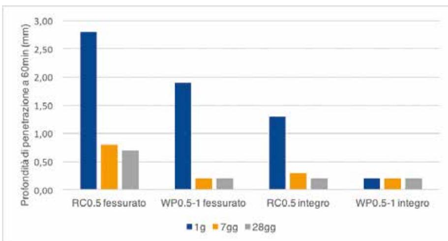
*Assorbimento di acqua determinata con tubi di Karsten sulla superficie integra o fessurata di lastre in calcestruzzo*
