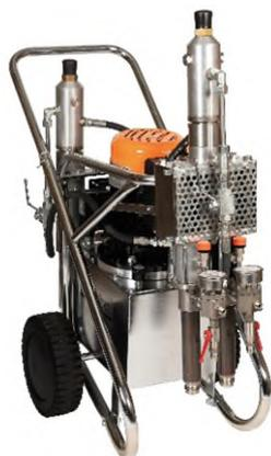
**Nota bene:** il tempo di reazione è significativamente legato alla temperatura della resina PU, della roccia ed eventualmente dell'acqua. Prima dell'applicazione si raccomanda di tenere i due componenti in stoccaggio a temperatura superiore a 15°. Per ottenere la migliore miscelazione dei componenti durante l'iniezione, è necessario utilizzare un mescolatore statico in linea abbinato alla pistola di iniezione.
