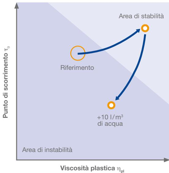
Un normale additivo viscosizzante rende stabile il calcestruzzo aumentando il valore di viscosità plastica ma l'aggiunta successiva di 10 litri d'acqua a m<sup>3</sup> riporta il calcestruzzo nell'area di instabilità.
