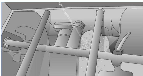
Mittels Pumpenhüben die Mischung solange bewegen, bis das Pulver vollständig aufgelöst ist. Die optimale Wirkung wird erzielt, wenn nach der Beigabe von MasterRoc<sup>®</sup> LUB I, 2- bis 3-mal rückwärts gepumpt wird. Dies sorgt für die optimale Durchmischung des Produktes.
