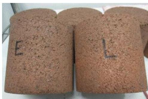
Sur béton pressé vibré, MasterPel 795 plastifie et permet ainsi de réduire le temps de mise en place ou d'augmenter la compaction.
