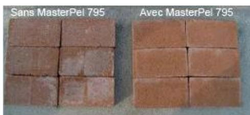
MasterPel 795 intensifie également la couleur des bétons et apporte une brillance après séchage.
