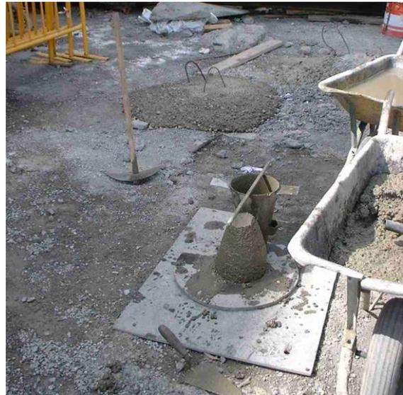
Se recomienda siempre la realización de ensayos previos para ajustar la dosificación óptima, pues la efectividad del aditivo depende de las características de los materiales empleados, factores externos como la temperatura, etc.
