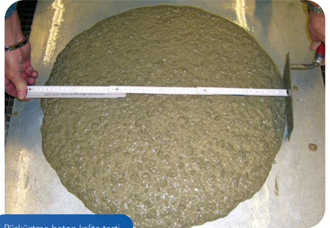
Püskürtme beton kalite testi
