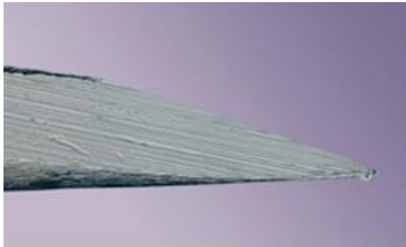
Agulha usada ampliada 370 vezes
