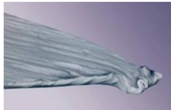
Agulha usada ampliada 2.000 vezes
