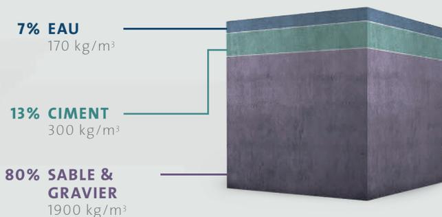
On parle de « béton normal » pour un poids spécifique (densité) de 2000 kg/m<sup>3</sup> à 2600 kg/m<sup>3</sup> au maximum.
