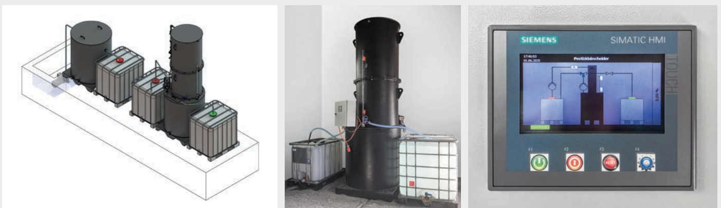
Fig. 5 Technische Behandlungsanlage für Waschwässer in der Landwirtschaft. Links: Anlagenkonfiguration mit GUS- und PSM-Modul; Mitte: PSM-Modul mit GAK-Säule für Waschwasseranfall bis 50 m 3 pro Jahr; rechts: benutzerfreundliche Steuerung mittels Touch-Panel (Siemens Simatic).
