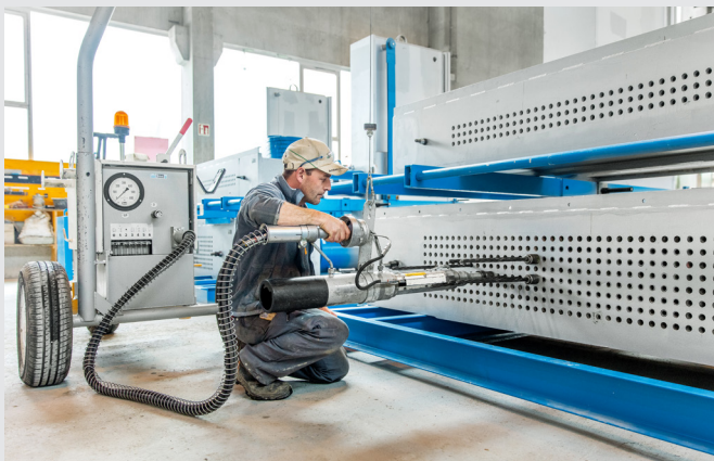
Vorspannen der Litzen der Rippendecken.
