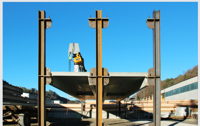
1:1-Mockup im Werk zur exakten Prüfung aller Elementabmessungen und so auch der Masshaltigkeit der Systemschalungen.
