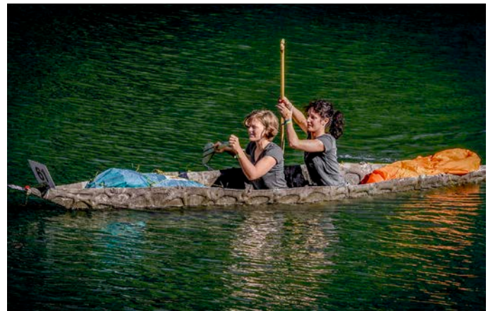
Liegt tief im Wasser, aber schwimmt: das KnitCrete-Kanu.
