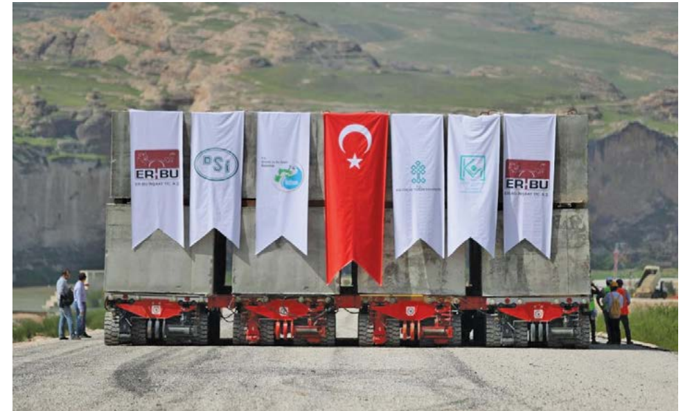
Beton Bloklarla Taşıma İşleminin Provası
