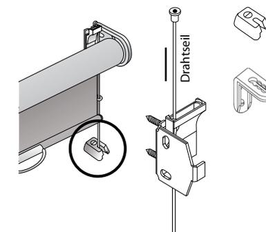
Spannschuh (wird am Fensterrahmen montiert)
