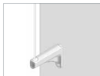
Abb. Spannseil Befestigung zur Wand
