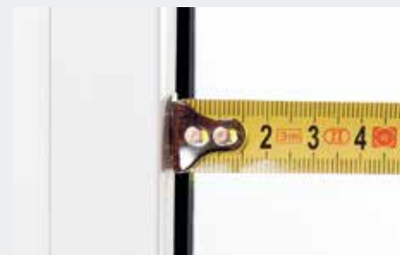
Gummidichtung schmaler als 5 mm
