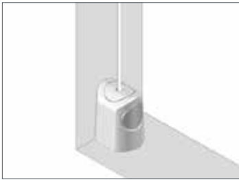
Abb. Spannseil Befestigung nach unten
