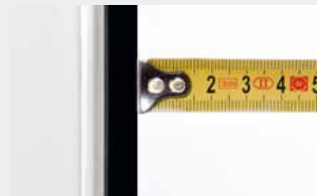
Gummidichtung breiter als 5,1 mm
