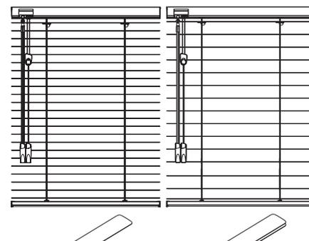
**Funktion:** Durch ein patentiertes Lamellen-Wendungssystem werden die Lamellen paarweise gebündelt und erlauben dadurch einen doppelt so großen Durchblick. Lieferbar mit allen 25 mm breiten Lamellen.
