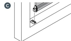
Piedino per il montaggio nel telaio della finestra
