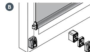
Fermacorda per montaggio nel vano finestra
