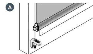
Staffa di tensionamento per montaggio a parete
