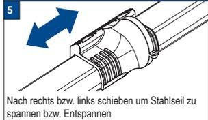
Nach rechts bzw. links schieben um Stahlseil zu spannen bzw. entspannen
