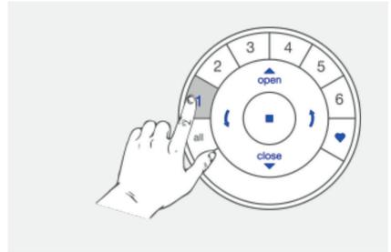
Drücken Sie die Taste close, um die Lamellen in die geschlossene Position zu bringen.
