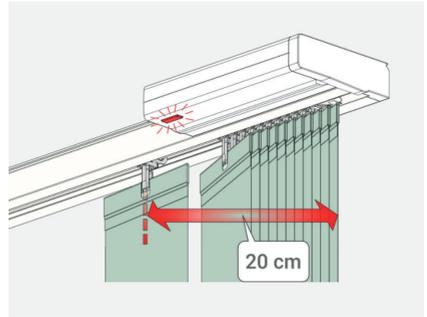
Verwenden Sie die Taste open, damit der Behang die mechanische Endgrenze erreicht. Der Motor bleibt stehen.
