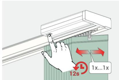
Die Anlage fährt 1x für 6 Sekunden und ein zweites Mal für 12 Sekunden auf- und ab.
