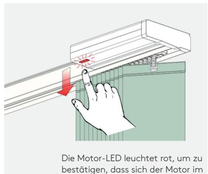
Die Motor-LED leuchtet rot, um zu bestätigen, dass sich der Motor im Programmiermodus befindet
