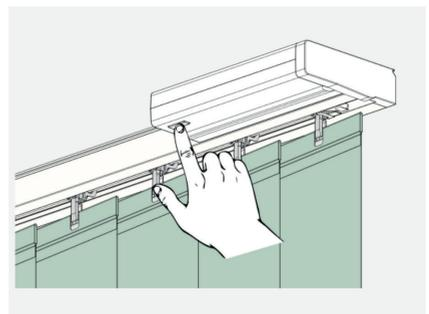
Halten Sie die arrow up Taste gedrückt bis die Motor LED rot leuchtet.
