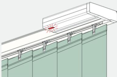
Die Motor-LED leuchtet rot, um zu bestätigen, dass sich der Motor im Programmiermodus befindet
