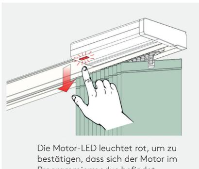
Verwenden Sie die Tasten open, stop und close, um die Anlage in die gewünschte Schließposition zu bringen.
