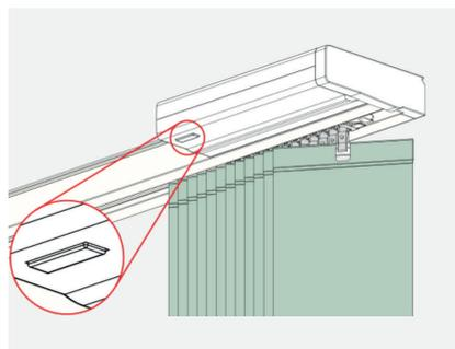
Halten Sie die manuelle Steuertaste für 6 Sekunden lang gedrückt.
