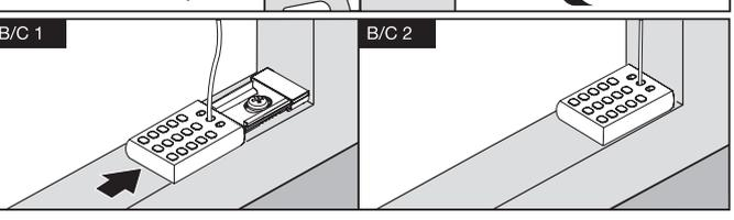
M7: Keile (11°) optional bei schräger Glasleiste
