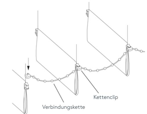
**Wichtig!** Jede Lamelle muss mit einem Kettenclip versehen sein.
