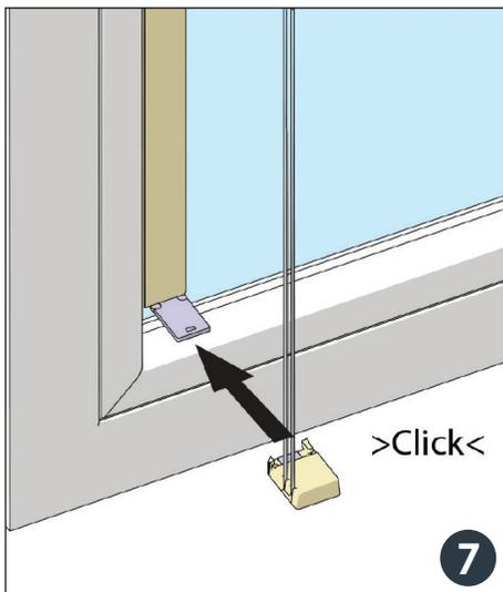
Nun die beiden unteren Spanschuhe aufschieben.
