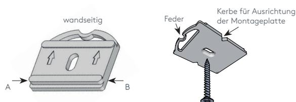
Richten Sie die Montageplatte mittels Schnurschlag oder Laser an der Decke aus. **Verwenden Sie alle für die Schiene vorgesehenen Montageplatten!**
