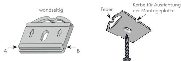
Richten Sie die Montageplatte mittels Schnurschlag oder Laser an der Decke aus. **Verwenden Sie alle für die Schiene vorgesehenen Montageplatten!**
