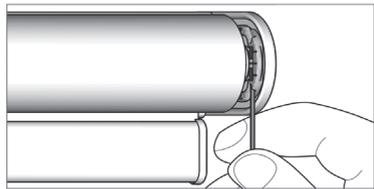
Dazu setzen Sie den Inbusschlüssel wie oben abgebildet, in die Inbusschraube des Trägers ein.
