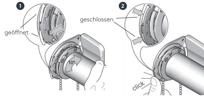
Verzahnung laut Abb. 1 einsetzen, 10° verdrehen und beide Sicherungsverschlüsse laut Abb. 2 einklicken.
