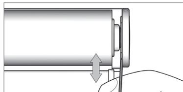
Drehen Sie nun den Inbusschlüssel nach links um die Höhe des Rollos nach oben zu verstellen und nach rechts, um die Höhe des Rollos nach unten zu stellen.
