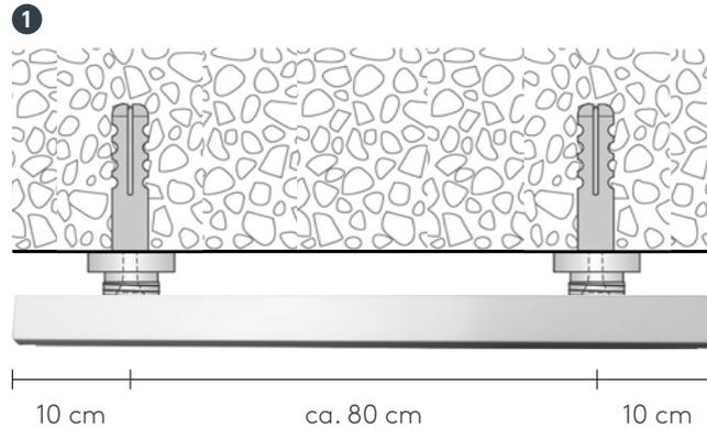
Die ersten beiden Deckenträger werden je Seite ca. 10 cm vom Schienenende nach innen montiert. Die restlichen Träger auf die Schienenlänge aufteilen und von Träger zu Träger ca. 80 cm Abstand berücksichtigen.
