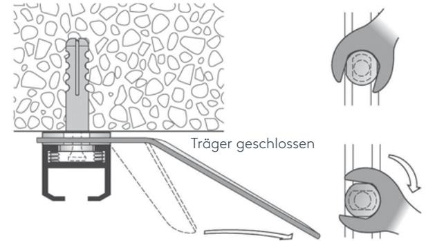
... und mit dem Gabelschlüssel die Träger fixieren.
