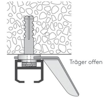
Schiene in die Träger einsetzen ...
