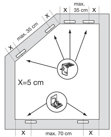
Trägermontage für schmale Fix-schiene
