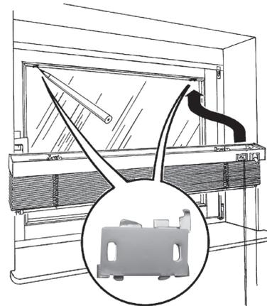
Träger öffnen. Oberschiene mit der Öffnung nach oben fest andrücken, mit dem kleinen Hebel unter der Bördelung fixieren.
