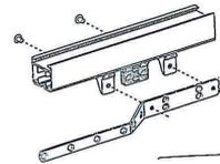
Schrauben Sie den Überzugbügel an.
