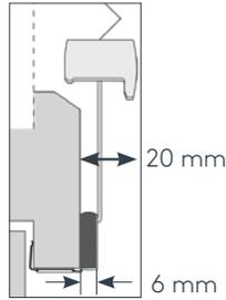
Sezione morsetto di fissaggio
