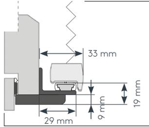
Sezione morsetto di fissaggio
