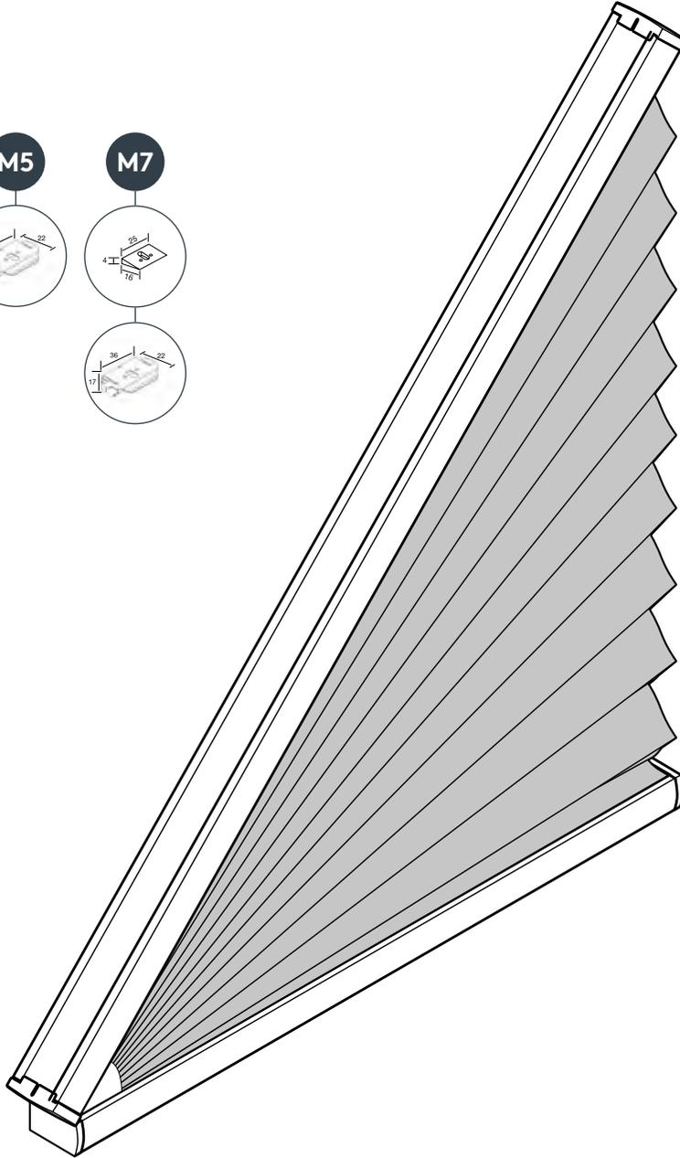
**Soluzione completa plissettata** a forma triangolare. Installazione fissa a parete, soffitto o finestra. **Non manovrabile.**
