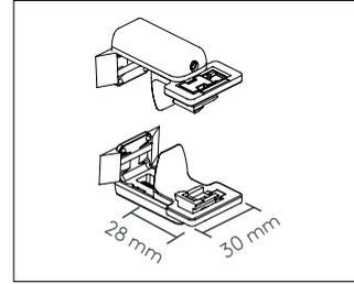
Morsetto di fissaggio adesivo
