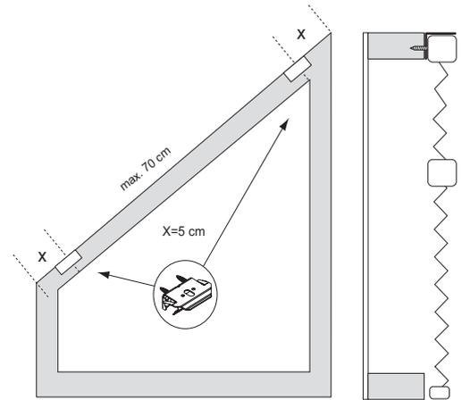
Die Oberschiene darf nicht unter 1,5m vom Fußboden aus montiert werden. Schnurwickler müssen so nah wie möglich an der Oberschiene befestigt werden, in allen Fällen jedoch über 1,5m vom Fußboden aus entfernt.
