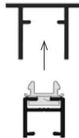
Einputzschiene in das Tragprofil eindrücken.
