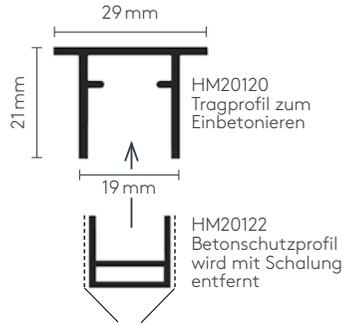
**! ACHTUNG:** Betonschutzprofil vorher silikonieren um das Entfernen zu erleichtern
