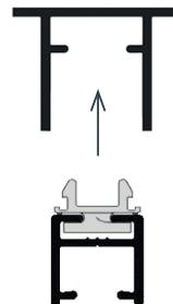
Einputzschiene in das Tragprofil eindrücken.
