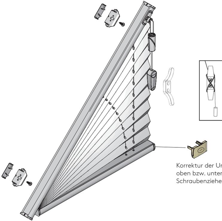
Korrektur der Unterleiste nach oben bzw. unten mit Schraubenzieher möglich.
