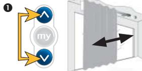
**Hinweis:** Wählen Sie durch einen kurzen Tastendruck eine Laufrichtung an, der Antrieb führt eine Referenzfahrt zur Erkennung der Endlagen „Offen“ und „Geschlossen“ automatisch durch. Warten Sie diesen Vorgang ab, bevor Sie mit der Programmierung des Antriebs fortfahren.
