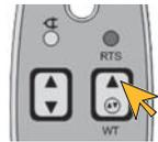
Fahren Sie mit dem Funksender den Behang in die gewünschte Zwischenposition (my).
