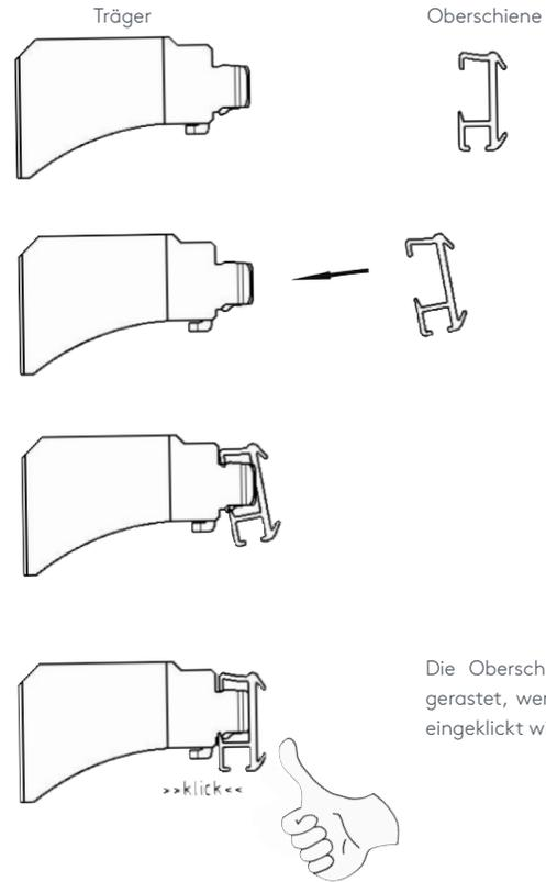
Die Oberschiene ist eingerastet, wenn der Hebel eingeklickt wird.
