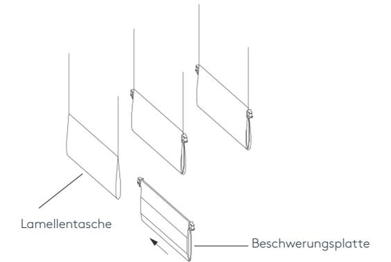
Die Kettenclips der Verbindungskette auf die vorderen Halter der Beschwerungsplatten aufstecken.
