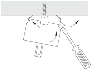
Mit flachem Schraubenzieher den Halter vorsichtig aufbiegen und Schiene entnehmen.
