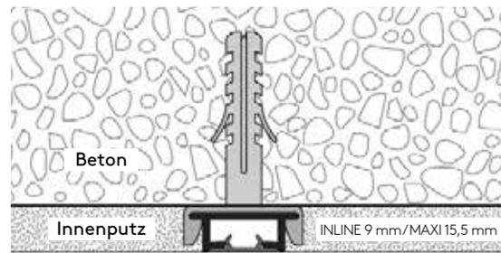
Laufschiene (wird nach dem Gipsen im halbfeuchten Zustand entfernt)
