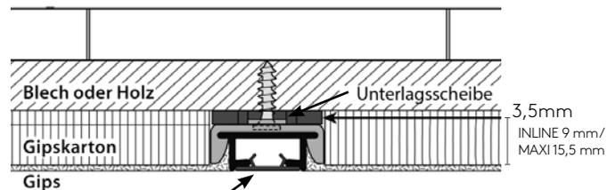
Laufschiene (wird nach dem Gipsen im halbfeuchten Zustand entfernt)
