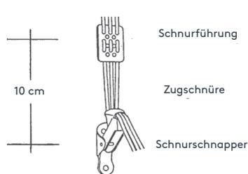
Vorhangschiene bzw. Liftteil mittels der Zugschnüre bis um Anschlag nach oben ziehen und Schnurführung ca. 10 cm oberhalb des Schnurschnappers einstellen. Danach fädeln Sie, wie in Abbildung ersichtlich, die Zugschnüre durch den Schnurschnapper.
