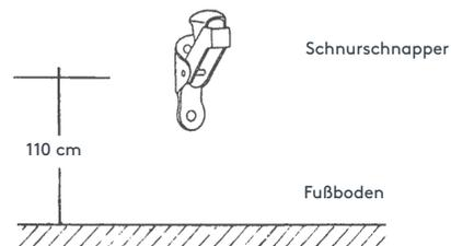
Den Schnurschnapper ca. 110 cm vom Fußboden entfernt an der Wand montieren. Achten Sie bitte darauf, dass die Zugschnüre von der Liftkarniese zum Schnurschnapper annähernd senkrecht verlaufen.
