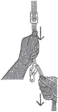
Ziehen Sie (wie in Abb. ersichtlich) die Zugschnüre in Pfeilrichtung und drücken Sie den beweglichen Teil des Schnurschnappers mit dem Daumen nach unten. Dadurch lösen Sie die Arretierung der Zugschnüre. Erst jetzt können Sie die Vorhangschiene bzw. den Liftteil absenken.
