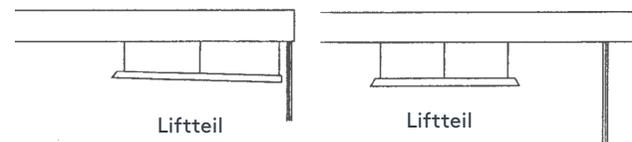
Wenn ein Teil der Vorhangschiene (Liftteil) am Ende der Liftkarniese gesenkt wird, stellen Sie die Zugsnüre über die Schnurführung so ein, dass er eine leichte Neigung zum Stoß hat.
