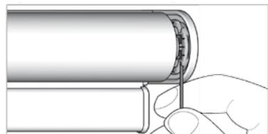
A tal fine, inserire la brugola nell'apposita vite del supporto (vedi figura).
