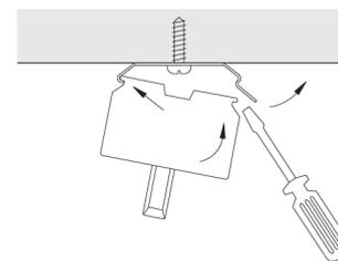
Mit flachem Schraubenzieher den Halter vorsichtig aufbiegen und Schiene entnehmen.
