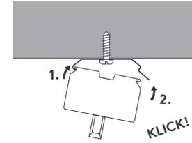
Schiene in die Halter einclippen bzw. mit Schraube festklemmen, je nach Art des Halters.
