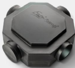
Elemento de polietileno de densidad media con forma tridimensional, octogonal y hueco. Tiene un diseño único, patentado para proporcionar una forma sencilla y eficaz de facilitar la despresurización o presurización del terreno, si se requiere posteriormente a su construcción. Se coloca en el terreno de grava, bajo el edificio.
