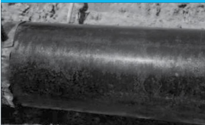
Tuyau en fonte ductile de 16 po (400 mm) recouvert de polyéthylène lâche de 8 mil.
