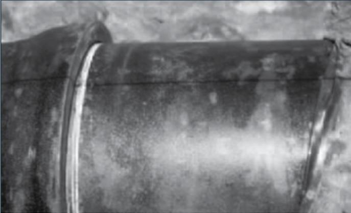
Tuyau en fonte grise 24 po (600 mm) recouvert de polyéthylène lâche de 8 mil.
