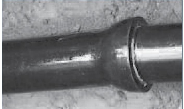
Tuyau en fonte ductile de 8 po (200 mm) recouvert de polyéthylène lâche de 8 mil.
