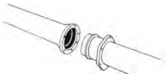
1. Limpie con un paño el hueco de la campana y el extremo liso. Inmediatamente antes de deslizar la empaquetadura en el extremo liso para ensamblar la junta, cepille la empaquetadura y el extremo liso con agua jabonosa o un lubricante para juntas espiga-campana aprobado, que cumpla los requisitos de la norma ANSI/AWWA C111/A21.11.
