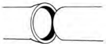
3. Asegúrese de que la forma y las dimensiones del bisel del extremo liso cumplan las recomendaciones del fabricante; los bordes cuadrados o afilados pueden dañar o desprender la empaquetadura y ocasionar una fuga. Cuando el tubo se corte en el campo, se deberá biselar el extremo liso con una lima pesada o una amoladora para eliminar todos
