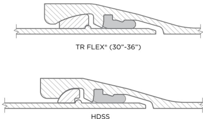
El método habitual de restricción de empuje es utilizar estas juntas especiales en la conexión y para un número predeterminado de tramos de tubos a cada lado a menos que, desde luego, la instalación completa esté restringida.
