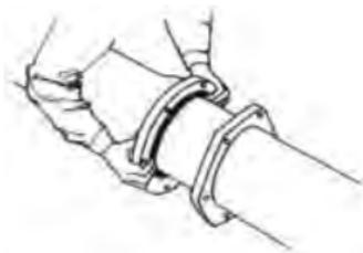
2. Introduzca el extremo liso en la cavidad y presione la empaquetadura de manera firme y uniforme en el hueco. Mantenga la junta recta durante el ensamblaje.
