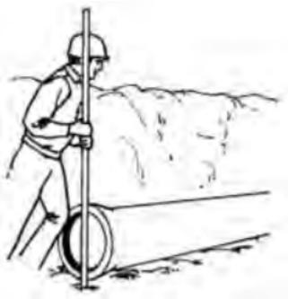
4. Los tubos pequeños se pueden empujar en la cavidad de la campana con una barra larga. Los tubos largos requieren una fuerza adicional, como la que proporciona un gato, extractor de palanca o retroexcavadora. El proveedor puede dar en alquiler un gato o un extractor de palanca. Entre el tubo y el gato o el cucharón de la retroexcavadora se deberá colocar un cabezal de madera para evitar daños al tubo.
