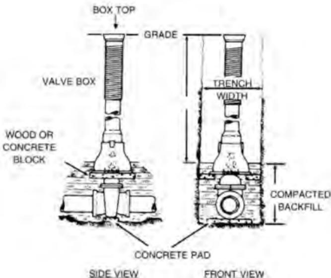
Las válvulas se pueden colocar en bóvedas de concreto o de mampostería o se pueden enterrar en el suelo con una caja de válvula u otro dispositivo, colocado sobre el operador de la válvula, que permita el acceso y la operación de la misma. Todas las válvulas con engranajes expuestos deben instalarse en una bóveda. El acceso a los pozos de registro debe ser lo suficientemente grande para permitir el retiro de la válvula si en el futuro fuera necesario reemplazarla.
