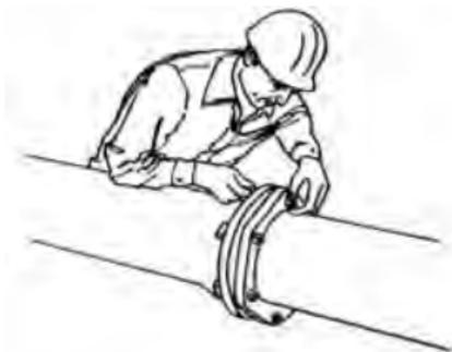
3. Empuje el collarín hacia la cavidad y céntralo alrededor del extremo liso con el labio contra la empaquetadura. Introduzca los pernos y ajuste las tuercas a mano. Realice la deflexión después de ensamblar la junta pero antes de ajustar los pernos.
