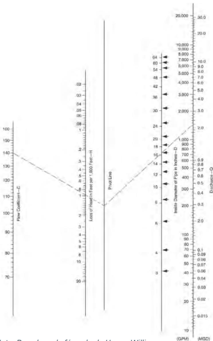
Nota: Basado en la fórmula de Hazen-Williams:  $Q=0.006756CD^{2.63}H^{0.54}$ . Para tubos de hierro dúctil revestidos con mortero de cemento,  $C=140$ . (↔) Se muestran los diámetros interiores reales de tubos de hierro dúctil revestidos con mortero de cemento de la clasificación de presión más baja disponible.
