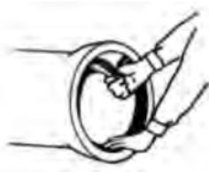
1. Limpie cuidadosamente el surco y la cavidad de la campana del tubo o la conexión; limpie también el extremo liso del tubo que se conectará o la conexión. Utilizando una empaquetadura de diseño adecuado para la junta a ensamblar, haga un lazo
